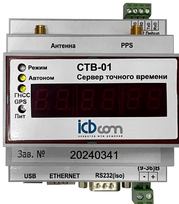
Рисунок 2.2.1. Передняя панель блока управления СТВ-01 (DIN) с ревизией корпуса P1.
