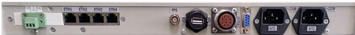
Рисунок 2.3 – Задняя панель блока управления СТВ-01 (с доп. функциями)
