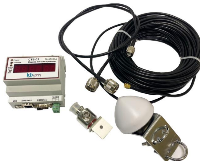
Рисунок 2.1 Общий вид сервера точного времени CTB-01(DIN).
