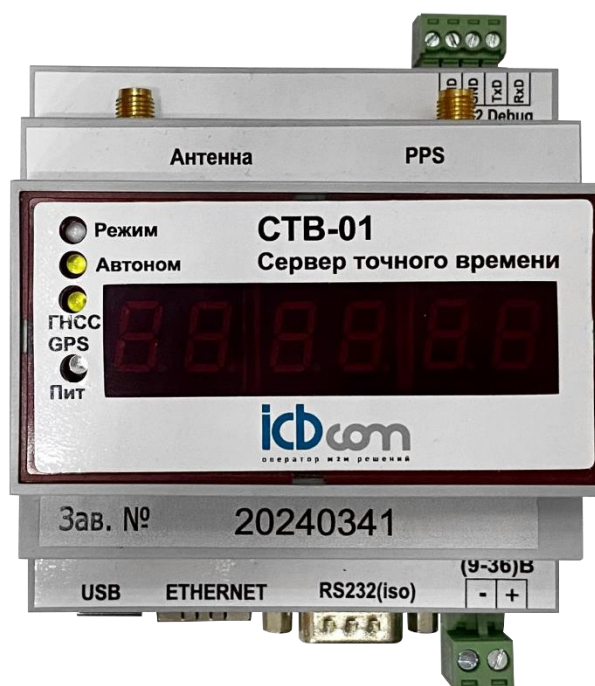
Рисунок 2.2. Передняя панель блока управления CTB-01 (DIN)
