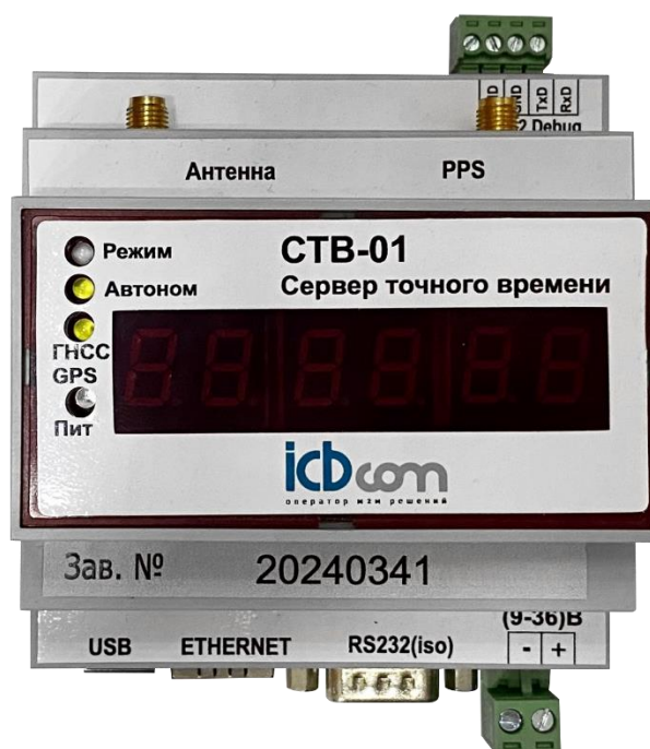
Рисунок 2.2. Передняя панель блока управления CTB-01 (DIN)
