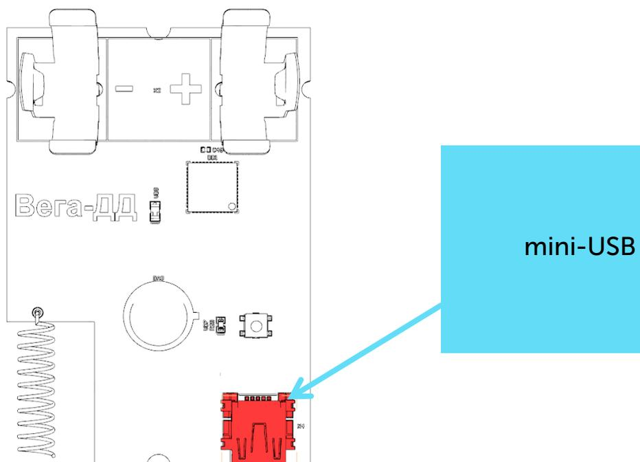
Перед первым подключением устройства к компьютеру необходимо установить драйвер для COM-порта **stsw-stm32102**, который можно скачать на сайте [iotvega.com](http://iotvega.com). После запуска исполняемого файла **VCP\_V1.4.0\_Setup.exe** появится окно установщика:
