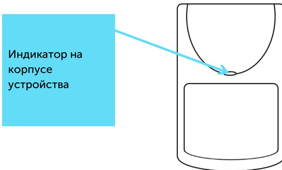
На плате расположен индикатор, сигнал которого виден только при снятой крышке и отображает состояние процесса регистрации в сети.
