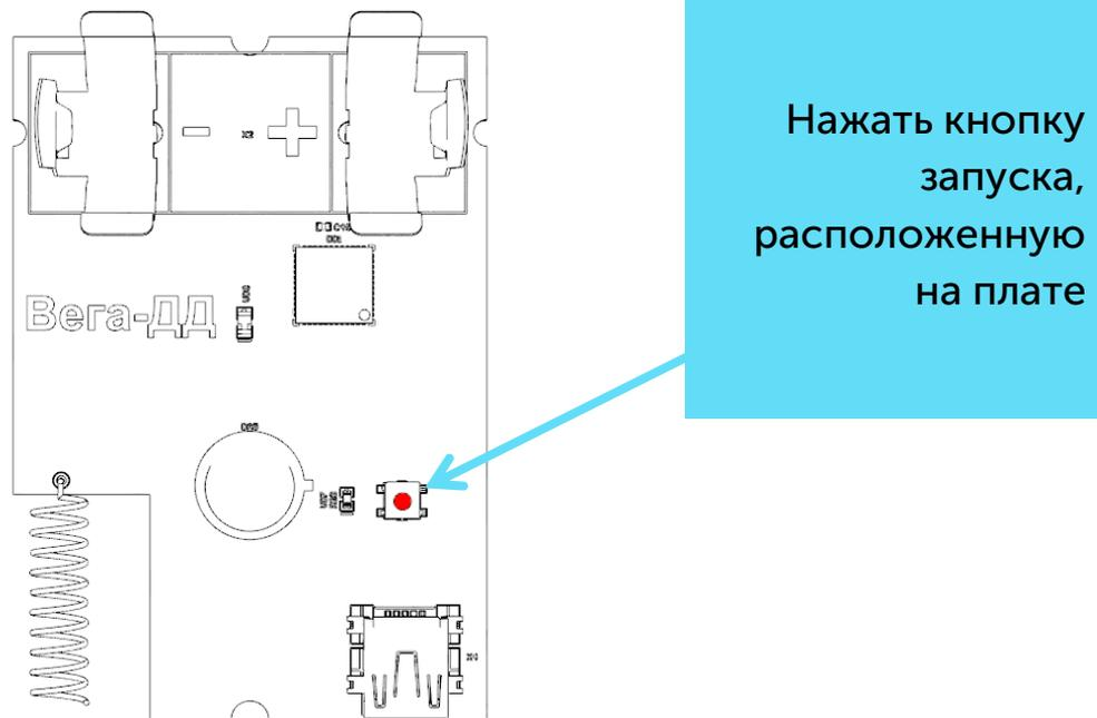
**2. Способ OTAA.** После нажатия на кнопку запуска, датчик осуществит три попытки присоединения к сети в заданном при настройке частотном плане. При получении подтверждения активации в сети LoRaWAN, датчик подаст сигнал индикатором (свечение в течение 5 секунд) и перейдет в режим «Активный». Если все попытки окажутся неудачными, датчик продолжит накопление данных и будет осуществлять попытки присоединения к сети раз в 6 часов.
