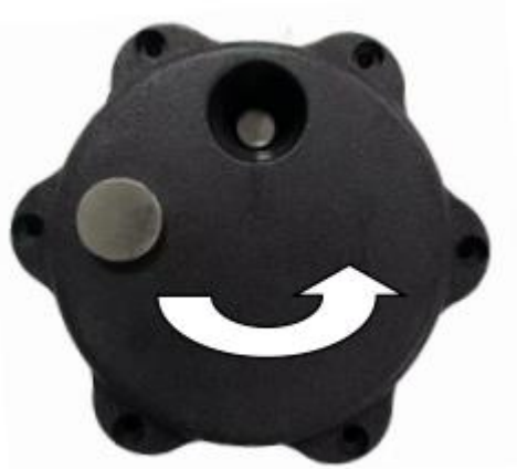
Рисунок 6 – Перезапуск датчика при помощи магнита
