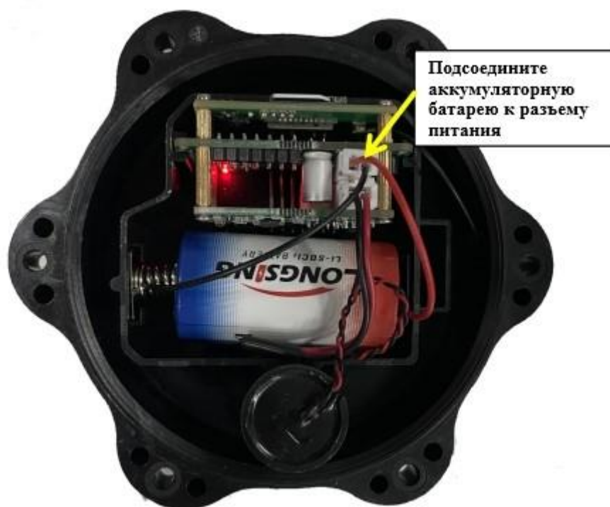
Рисунок 4 – Подключение аккумуляторной батареи
