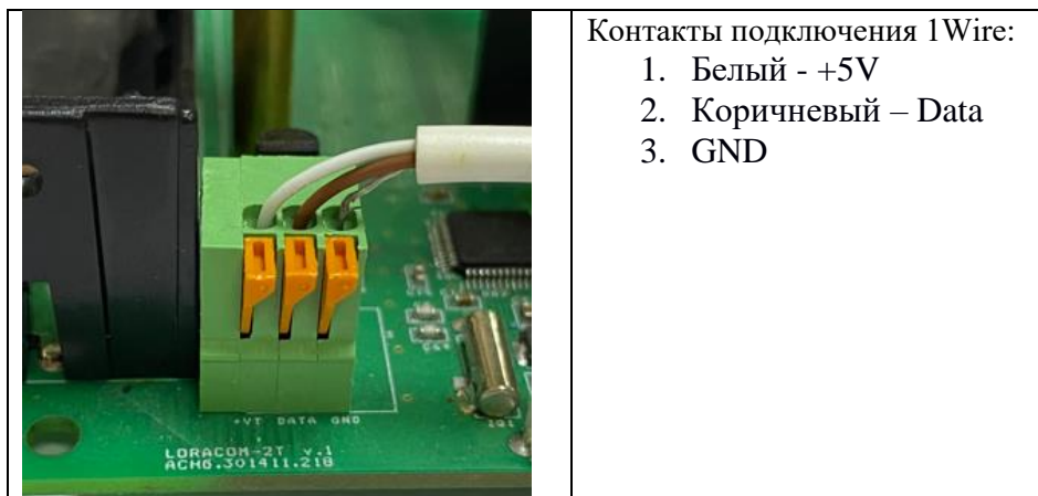
Рис. 1е – Подключение штатного датчика к УСПД.
